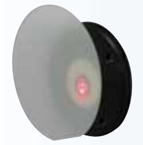
使用透明的蓝宝石样品，DIP可以观察到两个光束。
