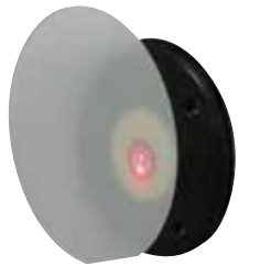
蓝宝石样品：因透明性可观测到两束光的位置。
