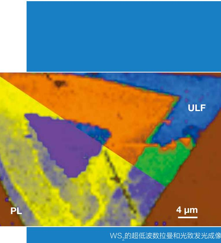
$\text{WS}_2$ 的超低波数拉曼和光致发光成像
