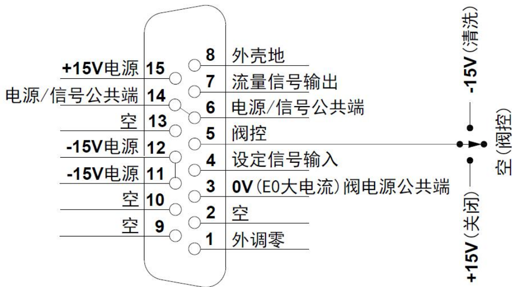
图五 DB15/F 孔型 插座接口定义图
