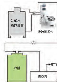
A. 旋转蒸发仪冷凝器真空接口
