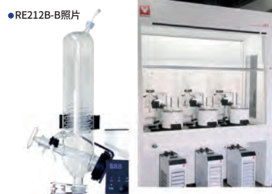
通风柜内设置3台纵型玻璃套装
