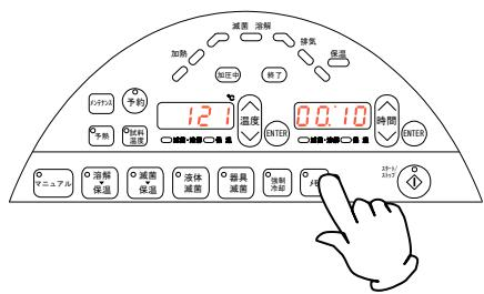
所谓强制冷却功能是指：在排气工艺中，启动冷却风叶，缩短冷却时间的功能。
