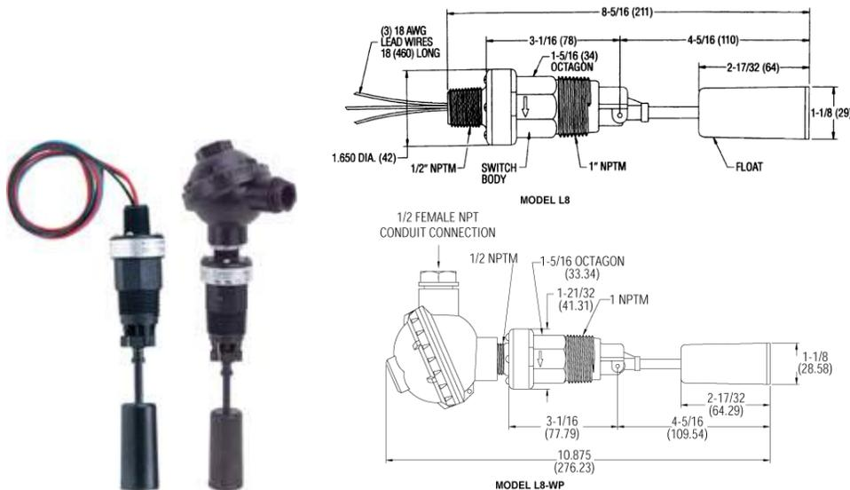
FLOTECT®L8 型液位开关包括无泄漏主体和浮子室由坚韧耐用和强抗化学能力的PPS聚苯硫醚特种工程塑料（即Ryton）制造。由于液位快速开关是由磁力控制的，没有直接的机械连接造成泄漏或故障，确保有更长久的寿命和更少的维修费用，这种并不昂贵的液位开关可理想用于液位的报警、指示、控制，安装容易简便——安置在水平方向，指示向下即可。
