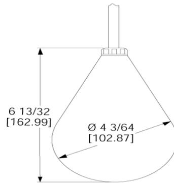
FSW2 系列自由浮子液位开关是一个双向开关应用于槽罐、井和蓄水池的排水和蓄水。外形和内部平衡重量确保杂质和污垢不会附着在表面上，可理想地用于污水和废水处理系统。不含水银的开关是装配在聚丙烯保护中的一个微型转换开关
