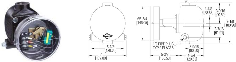
为锅炉应用而设计，123 型主要被应用于低水位关闭或供水系统控制，其它应用包括冷凝槽和脱气器。一个特别的快速反应开关装置消除了由于水的涌浪引起的频繁操作，透明包装可方便看到开关的动作，带法兰连接的主体可容易地清洁和替换浮子或开关，而不需要把整体从管线中拆下来。
