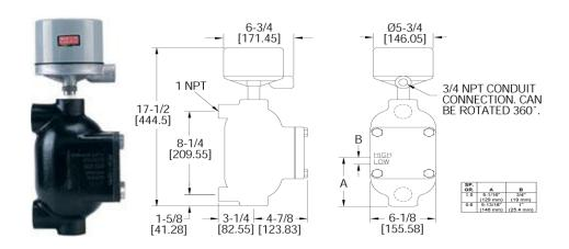
法兰连接检查板允许定期检查和清晰型号 102 的外室,它能够理想地应用于炼油厂、化工厂、和 其它潜在杂质的液体中。低成本的铸铁腔是标准配置,碳钢和不锈钢外室可特殊订货,不锈钢浮 子是标准配置。
