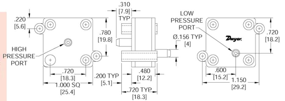
MDA 系列微型可调压力开关能测量差压。它能够现场调整设定点值，并且有金触头。空气或其它兼容流体可以在“高”端。轻便紧凑的尺寸使MDA 非常适用于空间有限的场合。它可用于工业，采暖通风空调，泵和发动机控制，医药工业，汽车工业，游泳池和温泉行业。
