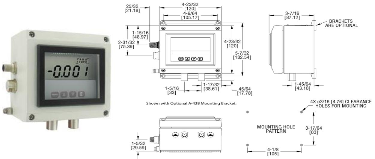
ISDP 系列差压变送器为 4-20 mA 过程输出，坚硬的 NEMA 4X 外壳，加上超大的液晶显示屏，可以编程读取压力，风速和流量。ISDP 系列为用户提供了简化的菜单键可供用户选择：安全标准；英制或公制的计量单位；压力，风速或流量操作；用于各种皮托管和流量传感器的 K-要素；用于测定体积流量的各种型号的圆形或矩形管道尺寸。ISDP 系列差压变送器通过两个 10-35VDC 的线圈和四个 M-124 针外螺纹接头运行。
