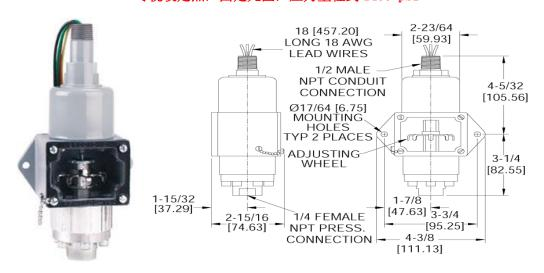
Mercoid 1000E, 隔膜 防爆压力开关,和 1000W 系列同样的牢固结构,加上防爆防护的设计。 UL 认证 I 级,A, B, C&D 组; II 级,E, F & G 组。弹簧动作可允许任意位置安装并且帮助防止 触头振动。还有过压保护和防震。
