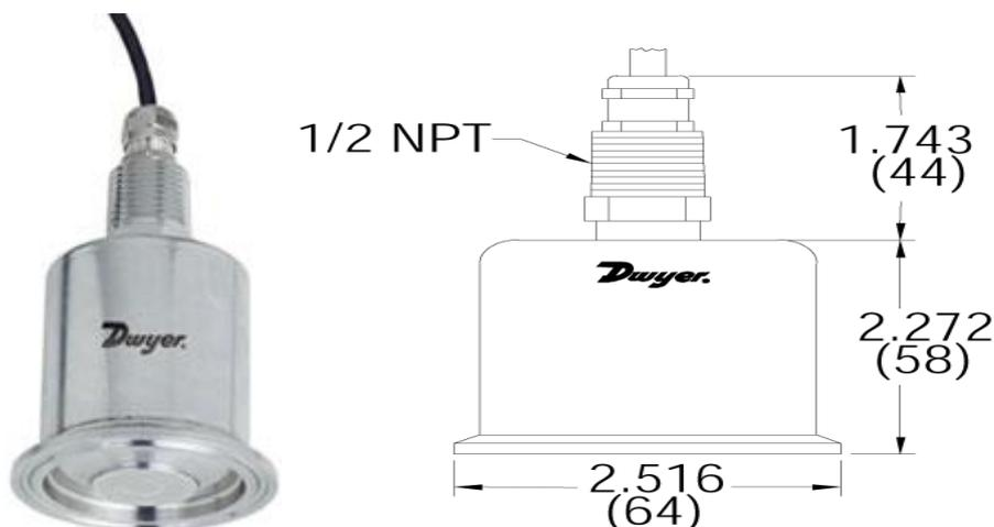
681 系列卫洁型压力变送器设计达到 3A 标准，可应用于食品，奶制品，饮料和制药加工行业，液位控制和卫洁管道。它被完全密封，能够经受清洁区（CIP）和消毒区（SIP）安装的高压冲洗。681 系列设计带有独特的，无液体填充膜片和一个 Tri-Clover 卫洁安装配件用于没有夹紧影响的简便安装。导管装置，铠装电缆，通风管，密封的调零和量程可调组合保证了 681 系列完全防水。
