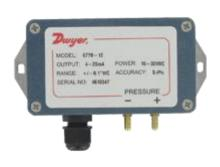
精度为±0.4% 的德威尔 677B 系列差压变送器,可以测量正压,负压和差压。它有聚碳酸脂外壳防护,等级为 NEMA 4X (IP65)。并且能够测量空气和兼容气体,输出 4-20mA 标准输出信号。内部调零功能。
