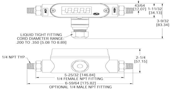
629 系列差压变送器可监测空气，兼容气体和液体的差压，具有 0.5%精度。设计应用双压力传感器将压力转变成标准 4-20 mA 输出信号，用于 2 线回路。内部小的移动空间和小的部件移动确保了快速的响应和稳定性能。接线盒，零位和量程打开上盖就能调整。629 系列差压变送器设计达到 NEMA-4X (IP66) 防护。
