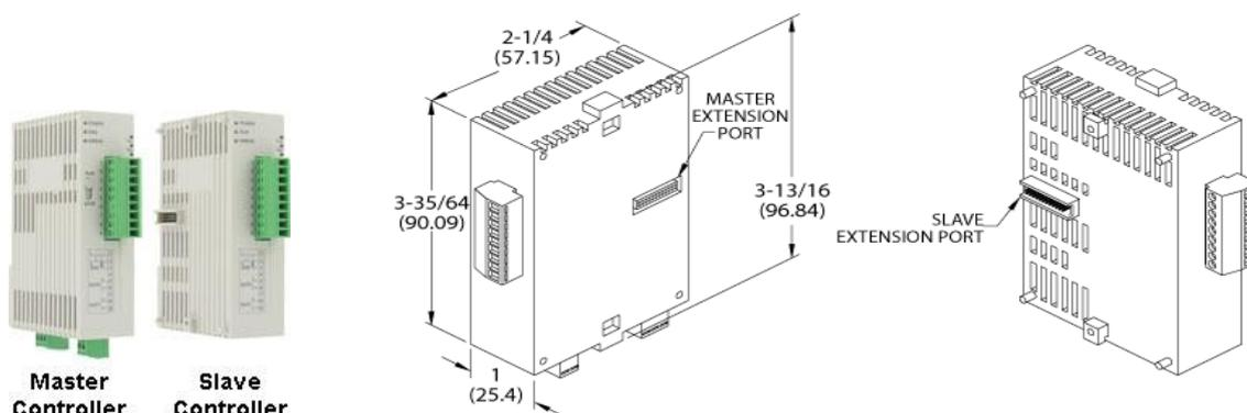
DIN 轨道安装 SCD 系列提供了多种 PID 回路在一个紧凑的外壳中。每个 SCD1000 主控制器可以结合多达七个 SCD2000 副控制器无需任何电线。每个控制器有一个通用输入，一个继电器输出，并有一个用户选择输出。这个输出可用于双回路来控制加热和冷却或单回路与警报。控制器支持高达 64 匝道/浸泡行为。SCD 系列控制器编程使用兼容的软件程序通过 RS - 485 的 Modbus® 通讯。
