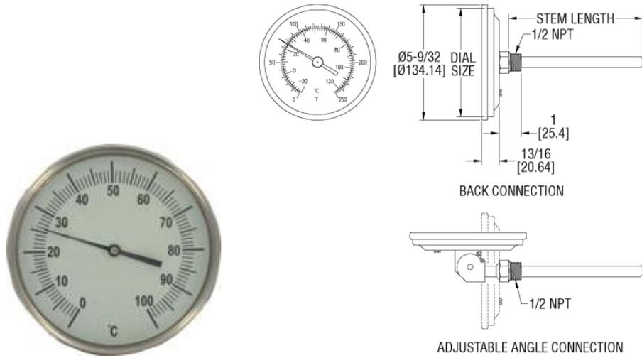
GBT 系列发光型双金属温度计在昏暗的地方可显示亮光，可以很准确和可靠的测量温度。双金属元件直接驱动指针，无需齿轮和联接。当安装在昏暗的区域时刻度盘会有亮光。玻璃透镜能很方便的清洁和防止磨损，并且更容易观察刻度。GBT 温度计可以提供不同的探头长度，连接和量程可选。
