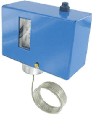
DFS 系列的低限冻结保护开关保护线圈冷却空气处理系统，以防止霜冻建立的线圈。通过检测的最低温度沿任何 1 段毛细管，手动或自动复位的双刀双掷继电器信号，以及切断风扇。设置点可以调整为 34°F 利用视觉设置点和指标设定螺丝。该系列中包括安装夹，安装容易。
