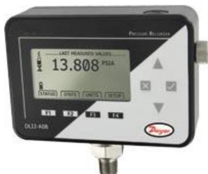
DLI2 系列可以准确记录压力并提供即时的远程读数。大的背光显示的 LCD 和 8 键按钮方便使用，记录当前的数据，并具有记忆功能。DLI2 可以定制测量范围达到 5000PSI。使用按钮和软件，计量单位可以读作 psi, in. Hg, mm Hg, bar, atm, Torr, Pa, kPa, 或 MPa。大容量的存储记忆功能可以存储 260000 个读数。简便的雨 DL700 软件创建永久记录，数据计算以及绘制简单的数据图表。DLI2 可以简单地使用 PC 进行开启或停止，也可以提前六个月设定开始时间。它也可以记录在读书后的特定时间的设置。
