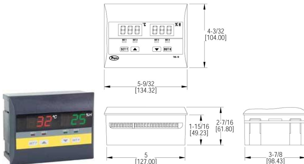
THC 系列温度/湿度显示开关可以同时测量控制温度和湿度。它提供一个3 位红色显示器显示温度，一个3 位绿色显示器显示湿度。THC 系列装有四个相互独立的继电器，两个用于温度控制，两个用于湿度控制。这个单元对于温度和湿度控制提供61 个可编程设定的参数，包括工作点，滞后差，正相/反相动作，周期，报警时间，和小数点位置调整。如果一个探头探测出现错误，继电器默认操作可以设置为开启或关闭。它具备错误/警报显示和密码保护功能。THC 温度/ 湿度开关可以承载二个温度探头输入（单独售出，见下表）和一个湿度传感器。0-1 V，0-3 V（见下表），或4-20 mA 输出的一个湿度传感器可以与THC 系列一起使用。
