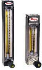
VA 系列玻璃流量计可以精确测量空气、水以及其它常用气体的流速。流量计的设计采用易读式通用毫米刻度,并提供相关图表包括校准数据资料,用作空气和水的参照物。该校准数据同样适用于其它气体和液体。标有垂直定位线的永久性熔融瓷质刻度盘可以减少视差,避免眼睛疲劳。较厚的聚碳酸酯前保护罩
