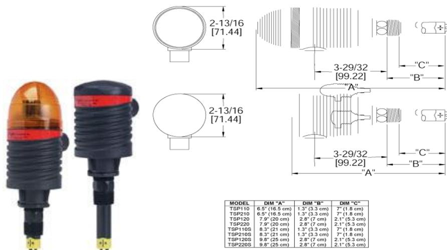
TSP 系列液体流量控制器用于在无流量时保护泵和阀门。TSP 系列将液体流量开关与可靠的继电器控制装置结合起来，可用于检测流量的有无，为泵和阀门的直接提供开关控制。控制器的功能包括：可调节延迟时间，可选常开或常闭操作，和传感器、继电器和电源状态的 LED 显示。四种型号（TSP110S, TSP210S, TSP120S, TSP220S）均设计有闪光报警器，可以即刻提供现场报警。
