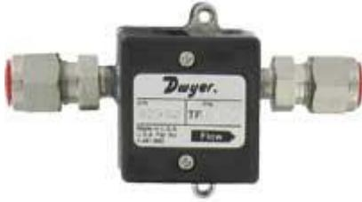
TFM-LP 系列液体涡轮流量计广泛适用于工业，商业和实验室流量的应用。流量计利用了涡轮和光电探测功能，将流速转换成直线 0-5VDC 输出信号，用于记录和数据的采集。流量计和 TM2 系列流量积算器的连接，用于远程流量的监测显示。操作时需要电源交换器或接合电线。
