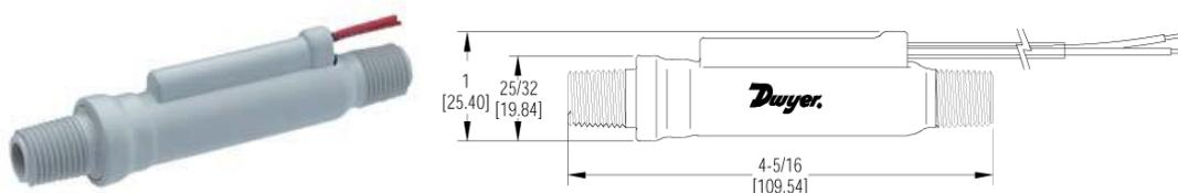
紧凑的P2 系列流量开关采用了活塞式设计，适于空气和纯净水。开关的预设动作点为0.05 到 1.0 GPM（水），25 CFH 到5CFM（空气）。活塞式设计与密封性双刀双掷电磁簧片开关结合为一体。P2 系列由Noryl 外壳和活塞，316 不锈钢弹簧和制动销组成，所有的材质都是FDA 认证的。经济优良的设计使得它成为净水设备、过滤器实时监控、热交换和冷却等应用方面的最佳选择。
