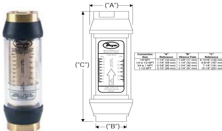
HF 系列管线流量监视器成本低,这个专利设计应用了浮动尖锐边缘孔板和变截面流量测量原理,在刻度中心以上1/3 的范围内精度达到了±2.5%。这一专利设计保证了精确测量粘滞度高达500 SSU的流体。所的内部零件都封装在一个密封金属管形套中,免去了维护的麻烦。流体推动弹簧做线性移动,尖锐边缘孔板和环形磁铁安装在锥形轴旁,环形磁铁带动流量管外清晰可见的随动磁铁移动,随动磁铁由透明的Lexan 管进行保护,随动磁铁上的指示环在直读式刻度上指示流量。此外,还有一个橡胶缓冲器用以缓冲防撞。
