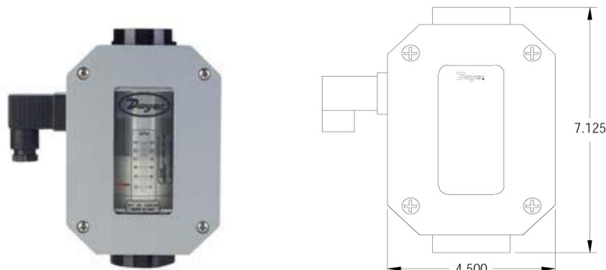
HF0 系列流量报警器可以连续不断地对流量进行监测和控制。流量报警器可以用于打开或关闭触点用来增加或减少流量设定。此系列包括两个带有现场可调报警设定值的10A 单刀双掷限位开关。它的直读式刻度可以对流速进行现场指示。流量报警器的安装方向不限，也不需要测量管路系统。HF0 系列封装在硬铸铝NEMA 4X (IP65) 防护外壳中，可以在室外或恶劣环境中进行安装。
