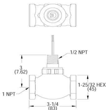
GVS 系列能精确的监测流量，重复性为1%，能够外部调整用与大范围的流量设定。无论是用于水或油，坚固耐用的结构都能保证长寿命的可靠性。直通流向使压降较低。GVS很适合于检测高容量润滑、冷却或加工系统中不正常的流量。
