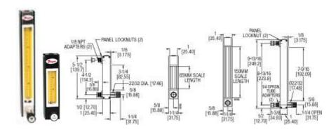
DR 系列直读式玻璃流量计可用来精确测量空气或水的流速并通过直读式刻度盘进行方便的读数。永久性熔铸陶瓷刻度盘于转子导向器结合为一体使转子有最佳效果。具有反射特性的塑料背景和 1.5 倍放大透镜可以减少眼睛的疲劳并能提供更精确的读数。其结构包括一个安全喷出背板,以进一步提供保护作用。 流量计在发货之前已完全组装好,包括标准面板安装件便于快速安装。
