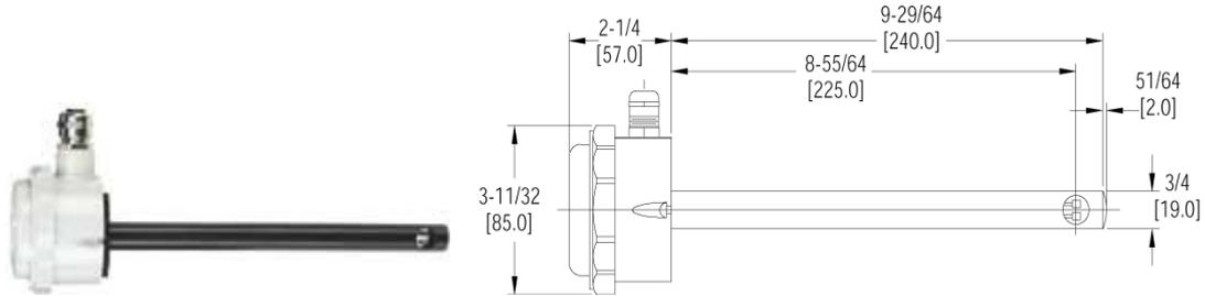
AVU 系列风速变送器是很理想的一款宽量程的用于 HVAC 测试和控制的应用，尤其应用于楼宇控制和能源监控系统。AVU 系列的精度为 5%，成本低，具有 6 种型号可供选择，量程从 0-785 fpm 到 0-3150 fpm，输出为 4-20mA 或者 0-10 VDC。
