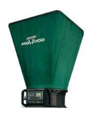
快速的获得精确的测量 HVAC 系统的气流分配。AFI 电子风量罩多样化的设计可快速获取数据,可适用于天花板,墙上的固定,楼层分布,用于供给或排气。可在大液晶显示屏上直接显示流量,可在永久存储器中存储 100 组读数以便进行分析。通过 A-547 RS-232 接口电缆(另售)可将数据下传到计算机中,消除了换算的麻烦。
