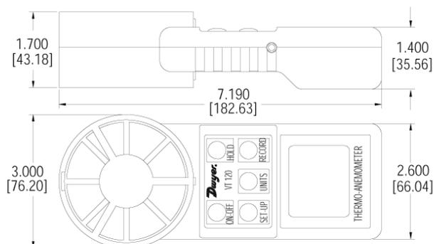
同时测量与模型8904积分叶片热风速仪风速和温度。大1.3"（34毫米）显示允许用户轻松地查看读数。用户可选择的风速的单位包括英尺/分钟，米/秒，结，英里和公里/小时。此外，一个内置的传感器记录的环境温度° F或° C.模型8904的功能包括数据记录能力，最小，最大和平均读数在一个单点和RS-232接口设置。单位也可以记录和平均长达2小时的数据而连续运行的平均显示。模型8904包括硬扛着的情况下，电池和指导手册。这个紧凑的表是理想的空调检查，能源审计和平衡中的应用。
