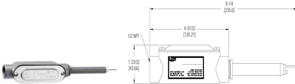
该系列 641B 风速变送器采用热式质量流量传感器技术。它有 4 个可选范围从 250fpm 至 2000fpm 与相应的公制不等的 1.25mps 至 10mps。641B 提供一个单独的 4—20 毫安的均衡的输出速度。
