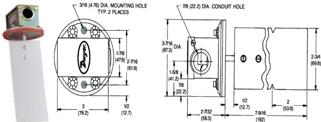
型号 530 气体流量开关灵敏度高，可靠性高，价格合理。特点为坚固的压铸主体，不锈钢叶片，单刀双掷快速开关。其现场可调整从 400 到 1600 FPM.。安装快速简单，只需两个螺钉。叶片适用于 6 英寸或更大的管道中。
