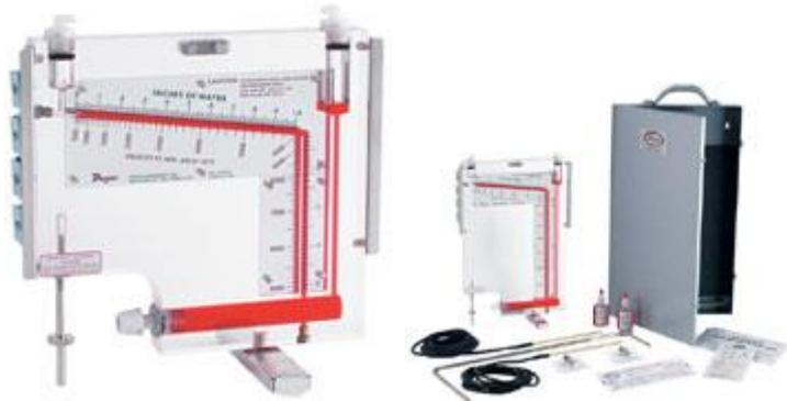
读取红色数字，单位为英尺每分钟，范围为 400-10000 f. p. m. 在标准状况下空气的测量无需转换曲线。读取黑色数字，代表气压，单位为英寸水柱，范围为 0-10" w. c.
