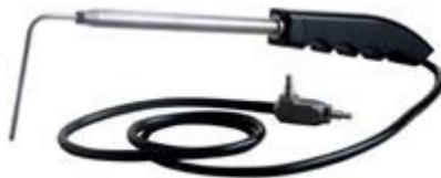
166T 型伸缩式皮托管是一个特有的气流传感器，它能够快速容易的适应与插入长度在 11.5 - 36 英尺 (29.2- 91.4 cm) 的管线。现在这个皮托管能够代替五种传统固定长度的皮托管。更大的方便在于它能够装在合身定制的聚乙烯携带式保护箱中。延伸式部件延长时能够自锁，这就容易实现手持检测时把取压口和气流方向对平行。不锈钢构造能防止腐蚀。半球状端头有 1.0 的流量系数，直径为 1/8" (3.2 mm)，最大部分为 3/8" (9.5 mm)。重量 (连同箱子) 1 lb, 9 oz (709 g) 箱子尺寸: 12.5X6.25X1.75 in.
