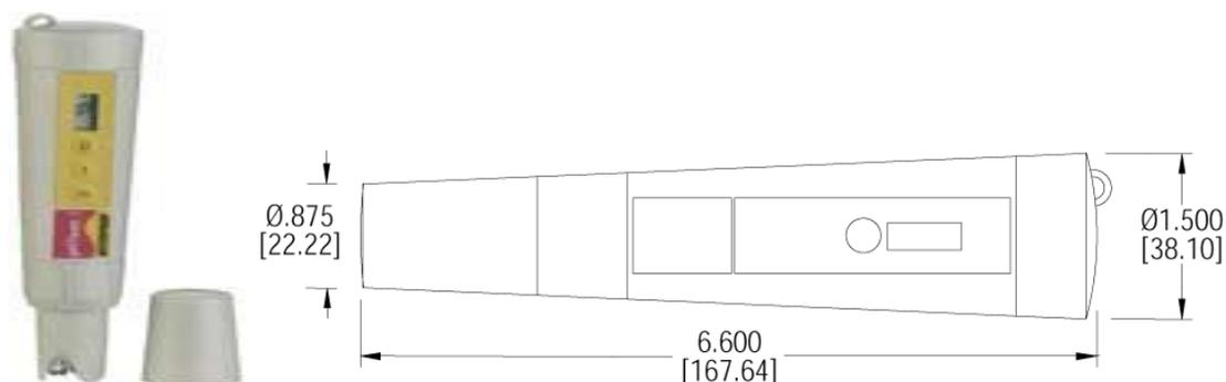
利用WPH 型号防水袖珍PH 测试仪可以高精度测量酸碱度。简单的按一下按键可以校准PH 型测试仪是否达到标准为4.0, 7.0或10.0 pH。防水外壳提供IP67 防护等级, 并且如果意外掉入水中可以漂浮。内置电池的整体很适合加上带索, 双O 型环密封, 可替换的传感器能够有助于防止污染物, 延长测试仪寿命。标准功能包括8-1/2 分钟闲置后自动关机, 显示保持, 过载, 低电量和错误检测信息指示。
