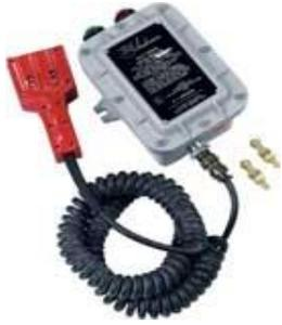
TR-7 型安全接地器提供卡车装车作业期间接地连接的连续监控。油罐车进入负荷区时常常会带来静电。如果油罐车没有良好接地，TR-7 型安全接地器马上停止装卸作业。简单，耐用的TR-7 型的电路可持续测量阻抗，它加载很小的电压到卡车接地触头的一端，另外一端连接到装卸夹上。如果安全接地器检测到经过接地触头的电阻有几欧姆，继电器会断开，控制电路也会切断。继电器不会闭合直到被良好接地。为了安全作业，安全接地器电路可以控制装卸泵-或者声光报警。和单线接地比较，双线的TR-7 系统提供一个额外的防爆，单线接地不能够测量装卸过程中的接地连接程度。TR-7 型Safe-T-Ground 安装容易简单。在防爆外壳上移开顶盖就可看到继电器和接地控制的接线排，且完整的布线原理图标在接线排边方便布线。线圈形的接地电缆/触头手柄很容易通过外壳上的小接口插拔。
