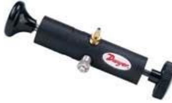
作为压力源来校准仪表和变送器或设置压力开关设定点值。和压力计或其他压力标准装置一起使用，带有精密控制调节器和排放阀。产生从几十分之一到 72psig (5bar) 的压力。包括快速接头，三通接头和 3 根 36 " 长的乙烯管。
