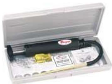
简单易用的烟气测量套件可以快速的平衡燃烧，生成最大量的 CO<sub>2</sub> 和最小量的烟气，以达到清洁、有效的燃烧。简单的取一个实际燃烧烟气的样品，然后和套件内的烟气对照表上的标准做比较好，仅仅用采样泵采 10 次就能够得到精确的测试样品，带有测试操作规程，使用说明书。
