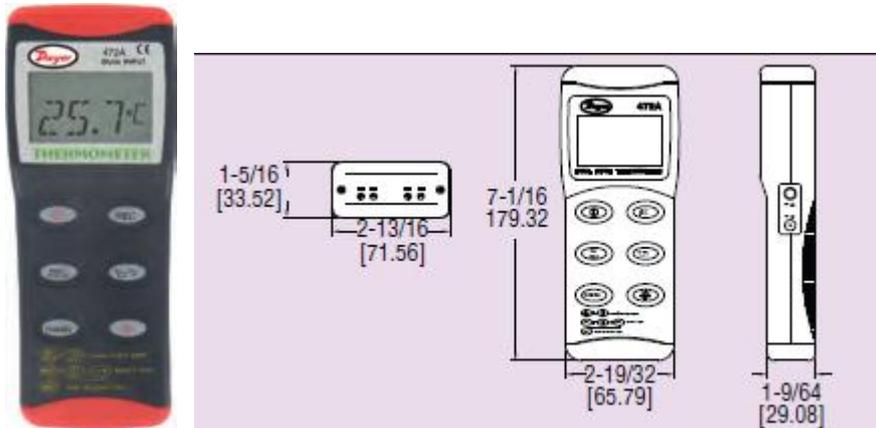
该型号 472a-1 双输入热电偶温度计准确的措施两个温度的同时测量。大型液晶显示屏显示温度输入或一个温度输入和温度差。任何 J, K, 或 T 型小型顶连接热电偶可以被用来作为一个输入。观察光线不足的环境中, 内置的背光源照亮显示器。一个按钮允许用户保持温度数据显示。最大和最小读数可以记录在设置的时间段。型号 472a-1 包括附件包括, 电池, 和一个 K 型热电偶。
