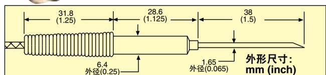
订购示例：**HYP4-16-1-1/2-100-EU-48-MTP-M**，RTD注射器状探头，带1.2 m (48")长的导线和MPT-U公连接器。
