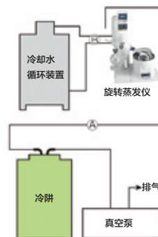
A. 旋转蒸发仪冷凝器真空接口
